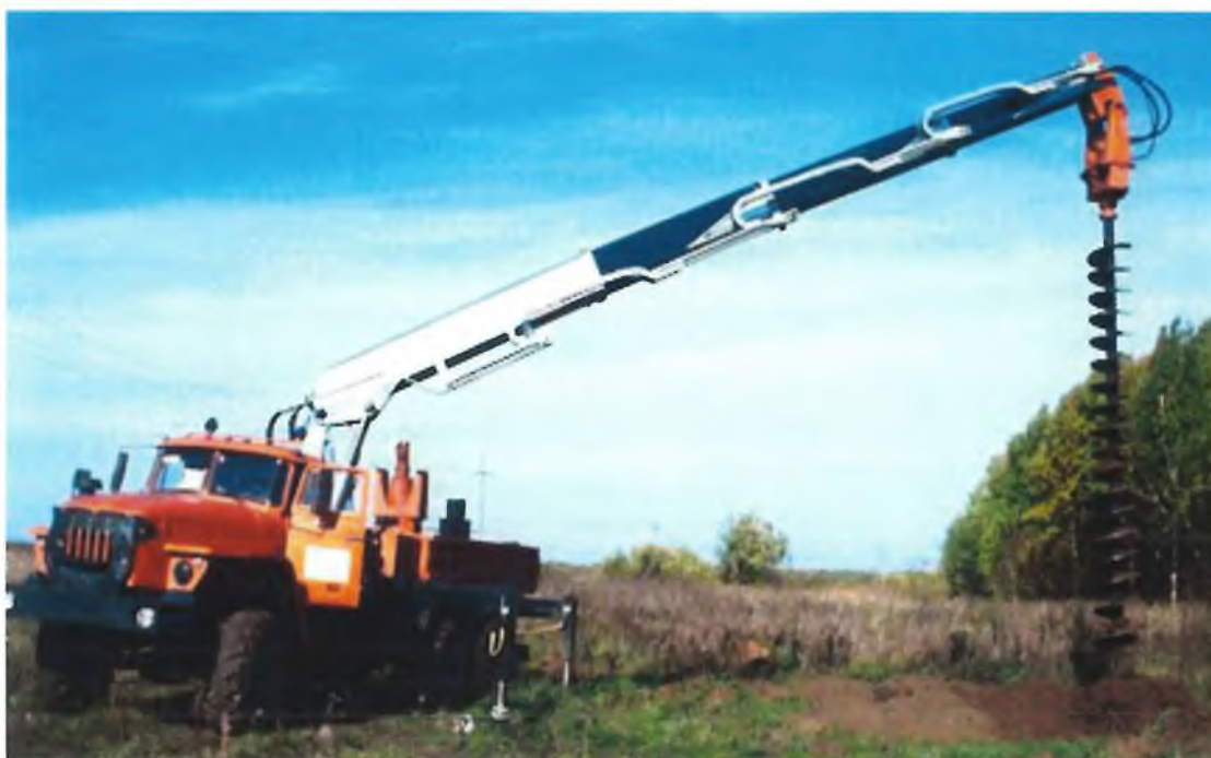
Рис.2. Бурение лидерной скважины с помощью бурильно-крановой машины.
