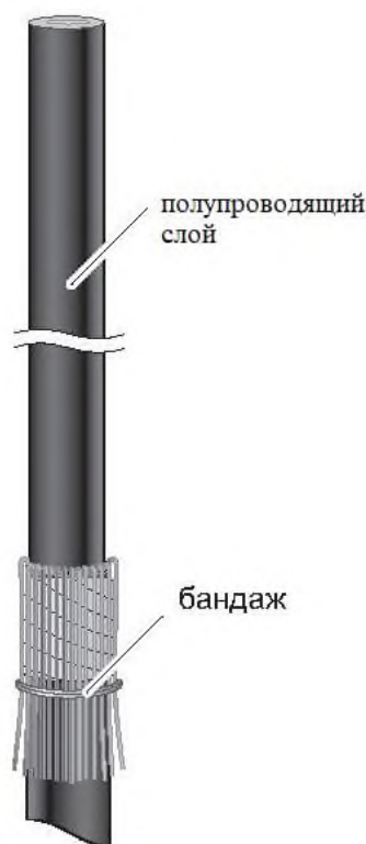
Рис. 3.5. Укладка проволочного экрана.
